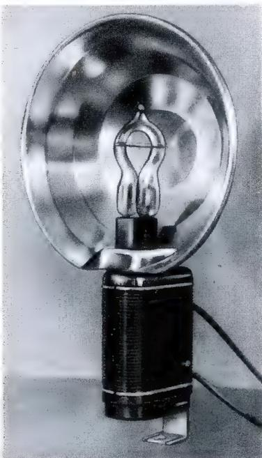
Links: Bild 3. Blitzlampe, gebaut unter Verwendung eines Agfa-Synchroblitzers für Vakublitz
