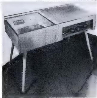
einem Plattenspieler und einem Kleinverstärker (ECL 82) versehen und erlaubt wahlweise Wiedergabe über den eingebauten Lautsprecher oder über ein Paar Stielkopfhörer. Die verhältnismäßig große Ablagefläche kann zum Aufstellen eines zusätzlichen Rundfunkgerätes dienen oder zum Ausbreiten und Ausschleusen der gewünschten Schallplatten (Akustic, Kurt Schröder, Berlin-Neukölln).
